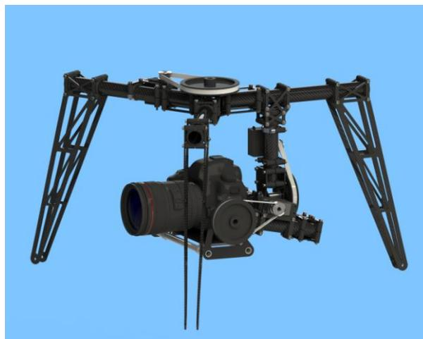
Рис. 2. Подвес топокоптера с фотокамерой
