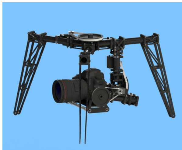
Рис. 2. Подвес топокоптера с фотокамерой
