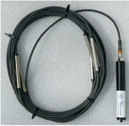
Рис. 7. Вид термокосы GeoPrecision [9] Fig. 7. GeoPrecision thermister string [9]
