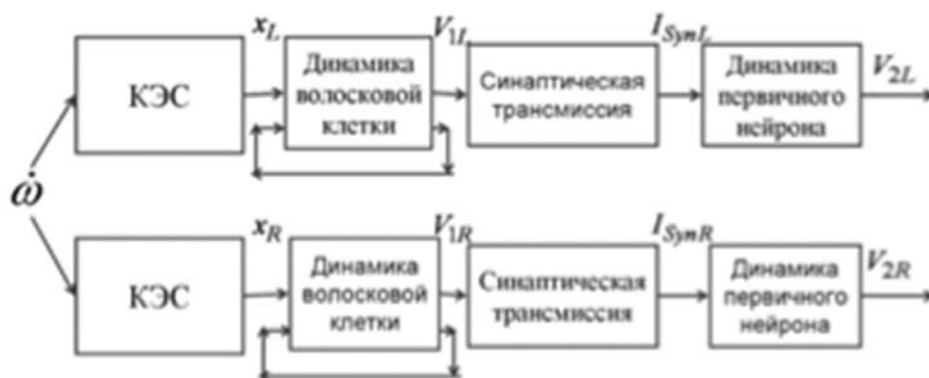
Рис. 1. Функциональная схема формирования выходной информации в биосенсоре углового ускорения при повороте в горизонтальной плоскости.
