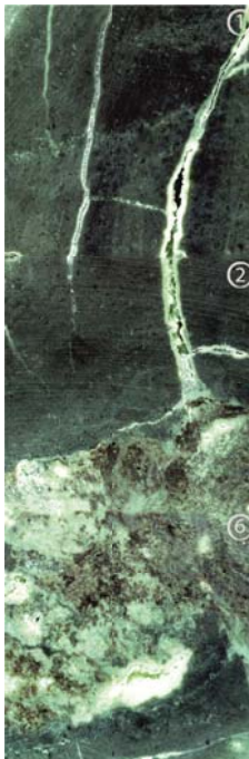
Рис. 5.27. Секущая вертикальная трещиноватость и минерализованная линза с редкими пустотами
