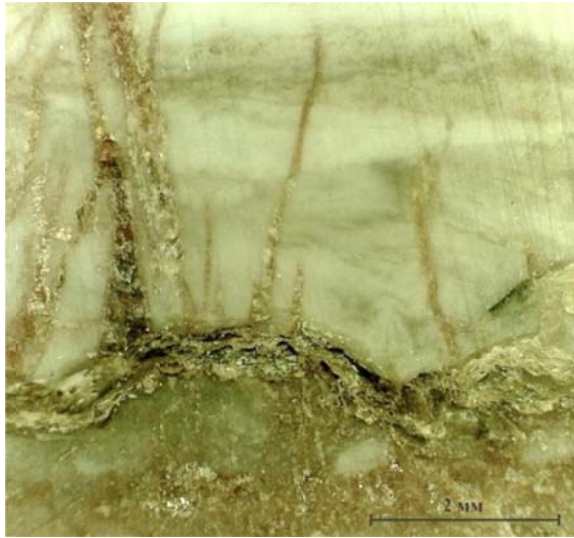
Рис. 4.17. Стиллолитоподобная извилистая трещина заполненная глинистыми минералами, разделяющая строматолитовые доломиты и кремнистые линзы. Скважина № 272. Образец № 18. Глубина 2575,94 м.
