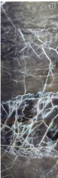
Рис.5.23. Различный характер трещиноватости в халцедоновой линзе и строматолитовом доломите. Скважина 198, обр. 3, глубина 2775,25 м.
