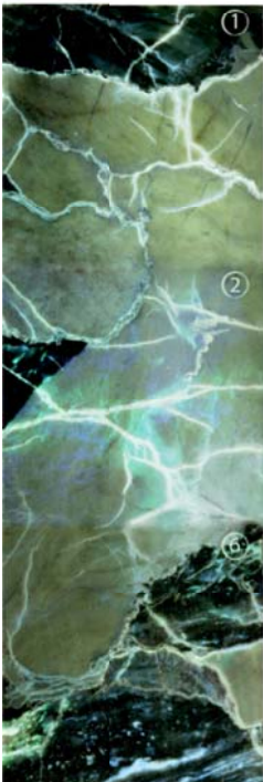
Рис.5.24. Неоднозначная характеристика трещиноватости в доломито-кремнистой брекчии. Скважина 272, обр. 18, глубина 2575, 94 м.
