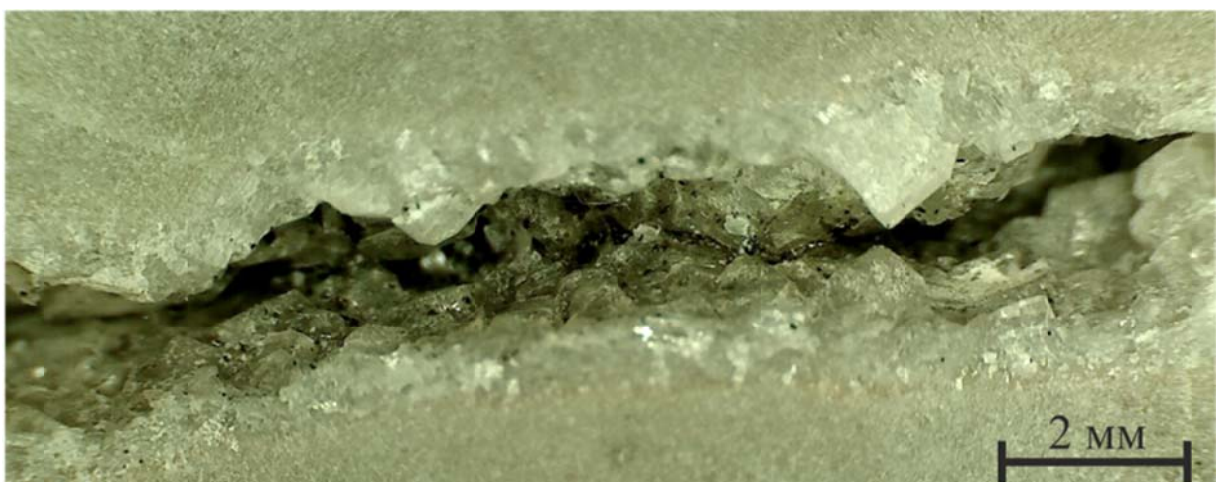
Рис. 4.13. Инкрустация полостей выщелачивания трещин препятствующая смыканию. Скважина № 120, образец № 101а, глубина 2422,90 м.
