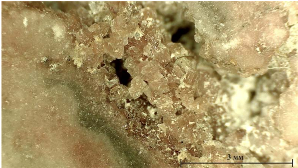
Рис. 4.8. Инкрустация стенок среднекристаллическим доломитом и частичное выполнение полостей каверны крупнокристаллическим доломитом в строматолитовом доломите. Скважина № 55. Образец № 8816. Глубина 2342,7 м.
