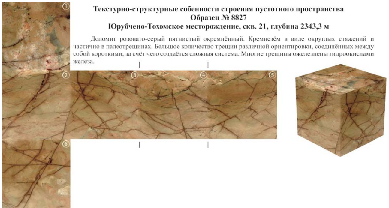
Рис. 5.1. Трещины окрашенные бурым цветом за счёт процессов ожежения.
