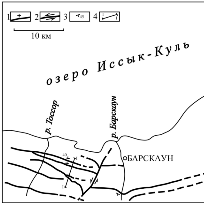
Рис. 5.13.1. Морфология Предтерской разлома (по Чедия и др. [1988] с изменениями). 1 – разломы (знаком + обозначено взброшенное крыло), 2 – сдвиги, 3 – элементы залегания сместителя, 4 – линии профилей.▲
