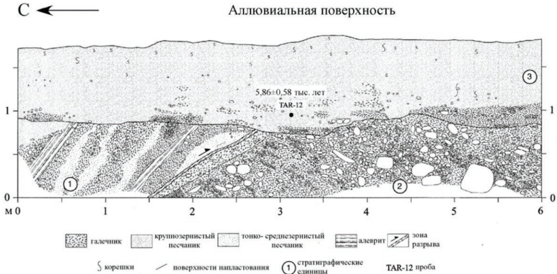
Рис. 5.2.2. Геологический разрез восточной стенки в южной (восточной) траншее (для местоположения см. рис. 29 Ю): вздернутое всиачее крыло Южно-Актекинского разлома сложено породами Иссик-Кульской свиты (толща 1), падающими под углом 47 - 54° на север. Разрывная плоскость почти достигает поверхности. Слои в лежащем крыле (толща 2) падают к югу под углом 27 - 38° и задираются вверх по разлому. Обе толщи срезаны эрозией и перекрыты рыхлым песчано-галечным аллювием (толща 3). По [Bowman et al., 2004], с изменениями.▲
