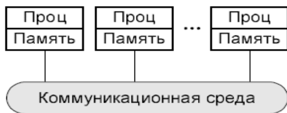
Рис. 4.1.2. Схема параллельного компьютера с распределенной памятью (Воеводин и Воеводин, 2002).
