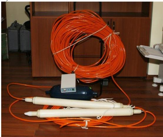
Рис. 1. Общий вид комплекта поискового буксируемого феррозондового магнитометра-градиентометра МФМГ-1.
