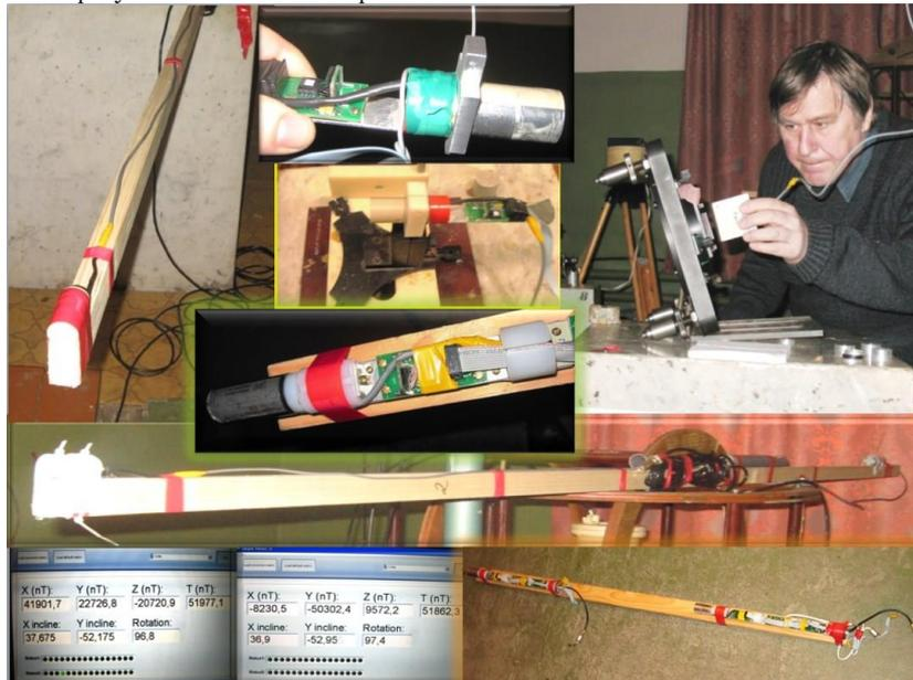
**Рис.3. Фото различных приспособлений изготовленных для исследования ФД.** Фрагменты фото с экрана дисплея ПК (внизу слева) при исследовании одного из измерительных каналов МЧД MFMG-1 с результатами измеренных значений составляющих (X, Y, Z) вектора ВМИ поля Земли и вычисленного модуля (Т) в процессе проведения методических работ. Здесь также представлены данные цифровых инклинометров (X, Y, R).
