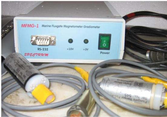
**Рис.2.** Общий вид двух ФД, применяемых в MFMG-1 (которые расположены в ПГ) и элемент бортовой части прибора – блок питания БП.
