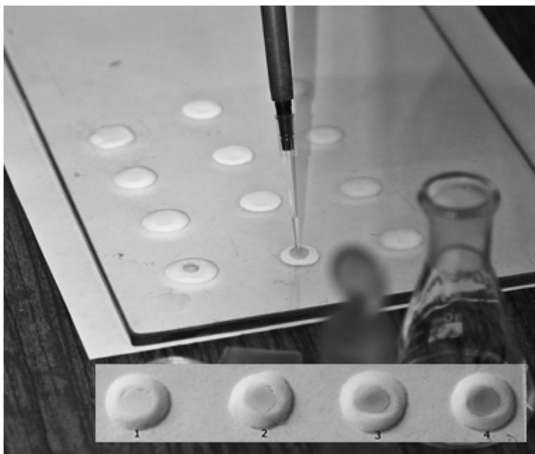
**Рисунок 1** – Определение суммарной серы в углеводородном топливе
