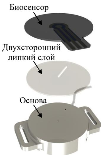
Рис. 2. Схема неинвазивного монитора
