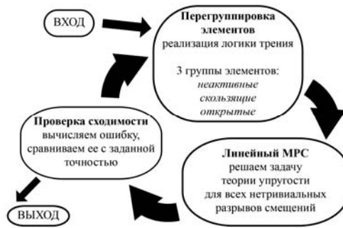
Рис.2. Блок-схема программы расчета взаимодействия неподвижной трещины гидроразрыва с природным разломом.
