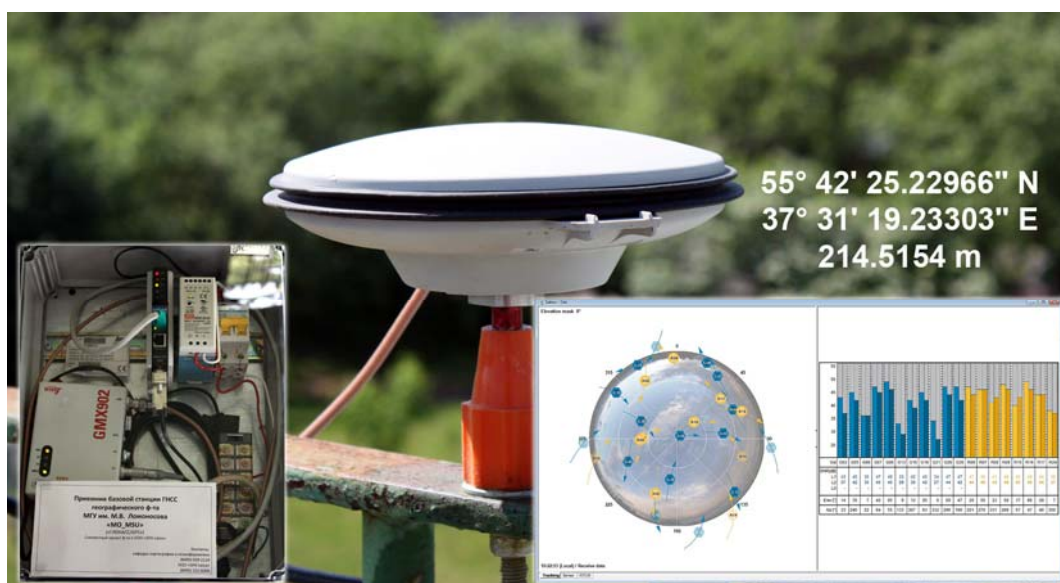
Рисунок 23.1. Комплекс ДГС ГНСС «МО_MSU» на здании метеообсерватории МГУ (антенна ГНСС, приёмник, интерфейс приёма сигналов спутников в реальном времени)
