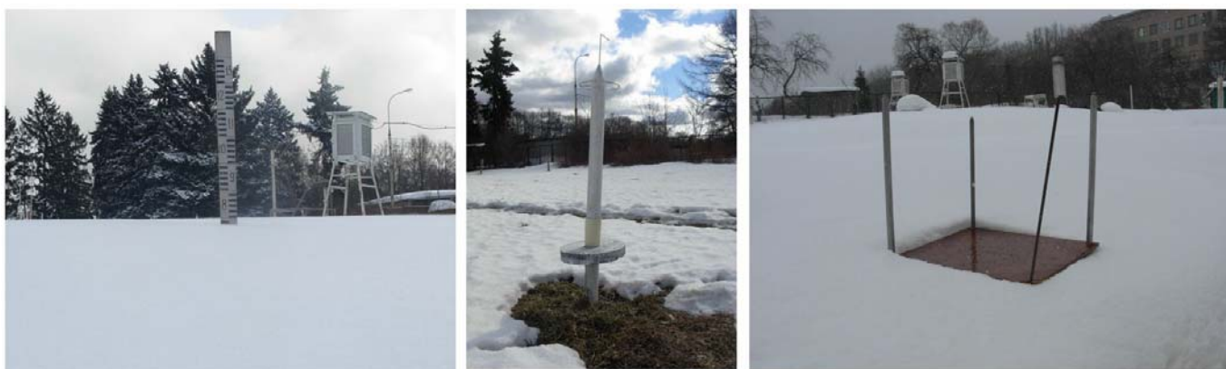
Рисунок 4.1 , слева направо: снегомерная рейка М-103 (рекордный отсчёт 77 см 26 марта 2013 г.); ледоскоп; планшет для измерений прироста снега. Москва, МО МГУ. Фотографии автора
