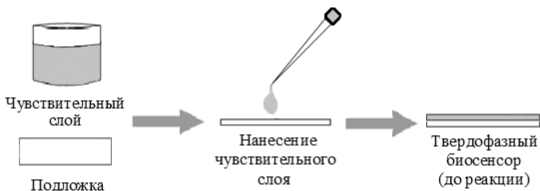
Рис. 19. Схема формирования чувствительного слоя оптического биосенсора.
