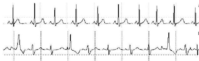
RYCINA 1. Sztuczne elektrokardiogramy, wygenerowane w wyniku modelowania matematycznego na podstawie jednego (a) oraz dwu (b) wzorców.
