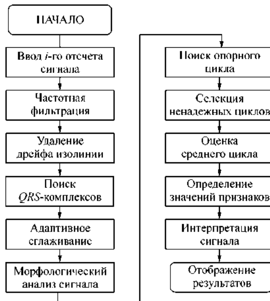
Рис. 6.27. Укрупненная схема обработки сигнала в реальном времени
