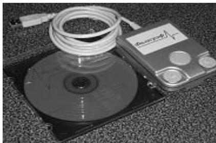
Рис. 13. Компьютерная система ФАЗАГРАФ (сенсор и диск с программным обеспечением)
