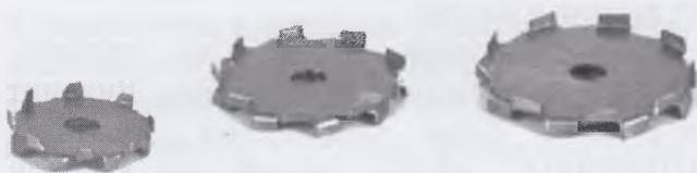
Рис. 5. Конструкция стандартной фрезы для перемешивания лакокрасочных материалов [4]
