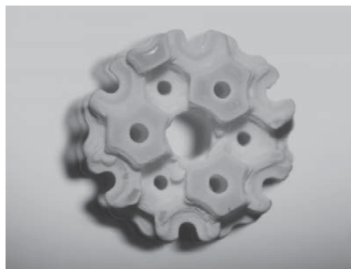
Рис. 2. Фотография композита с архитектурой Кельвина вдоль направления [111]; диаметр пор 500 мкм.
