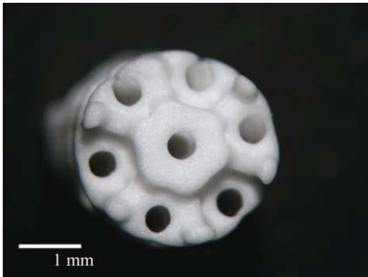
Рис. 9. Фотография керамического имплантата с архитектурой Кельвина вдоль направления [111]; диаметр пор 750 мкм.
