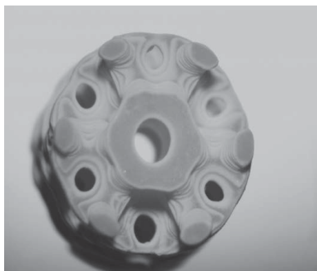
Рис. 1. Фотография композита с архитектурой Кельвина вдоль направления [111]; диаметр пор 750 мкм.
