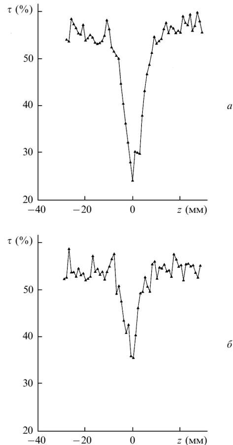
Рис.4. Экспериментальные результаты z-сканирования исследуемой суспензии, полученные при фокусировке излучения на длине волны 1064 нм линзой с фокусным расстоянием 100 мм при  $\epsilon_{in} = 90$  (а) и 30 мкДж (б).
