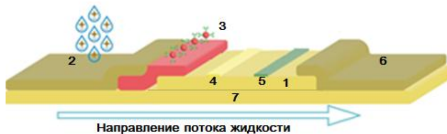
Рис. 1. Схема строения ЛПИИ тест-полоски: 1) аналитическая мембрана; 2) мембрана для образца; 3) мембрана для конъюгата; 4) тестовая линия; 5) контрольная линия; 6) впитывающая мембрана; 7) пластиковая подложка.
