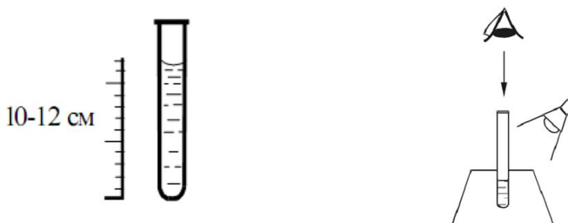
2. Определите цветность воды, рассматривая пробирку сверху на белом фоне при достаточном боковом освещении (дневном, искусственном). Отметьте наиболее подходящий оттенок из приведенных в табл. 1, либо заполните свободную графу в таблице.
