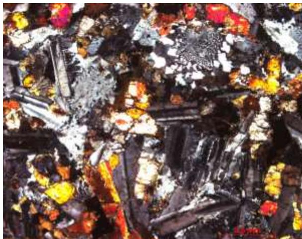
Рис. 3.2.9. Гранофировые габбро с многочисленными микропегматитовыми кварц-полевошпатовыми срастаниями. Призматические кристаллы с низкими окрасками – плагиоклаз, изметричные выделения с желто-красными – клинопироксен. Шлиф 3552, с анализатором
