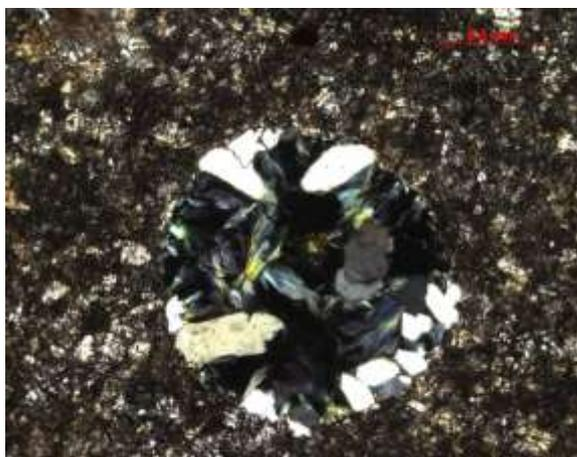
Рис. 3.3.4. Стекло, замещенное кристаллами кварца и тонкими скелетными выделениями рутила. Слева округлый резорбированный вкрапленник бесцветного кварца. Микрофотография шлифа 3714-14. Николи параллельны
