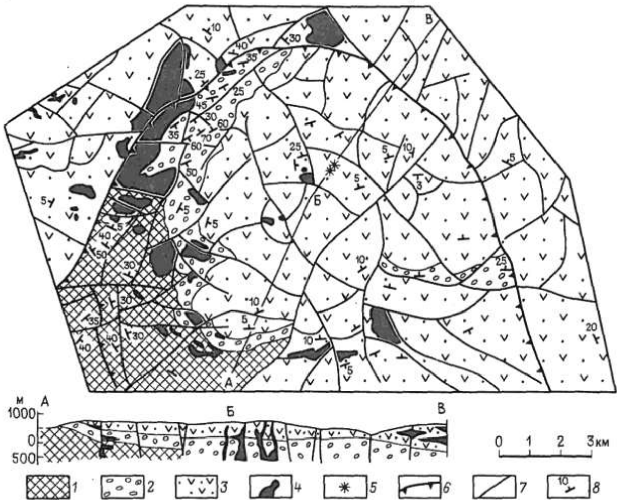
Рис. 2-38. Строение Микинской кольцевой вулканогенной структуры Пенжинского сегмента ОЧВП [Филатова, 1988]. 1-2 – фундамент ОЧВП: 1 – вулcano-терригенные отложения готерива, входящие в состав комплексов Удско-Мургальского пояса); 2 – терригенные отложения альба; 3-5 – образования ОЧВП: 3 – вулканиты среднего и основного состава (альб-сеноман), 4 – позднемеловые субвулканические образования среднего и основного состава, 5 – вулканические жерловины; 6 – периферические дуговые разломы Микинской структуры, 7 – прочие разрывные нарушения, 8 – элементы залегания геологических тел.
