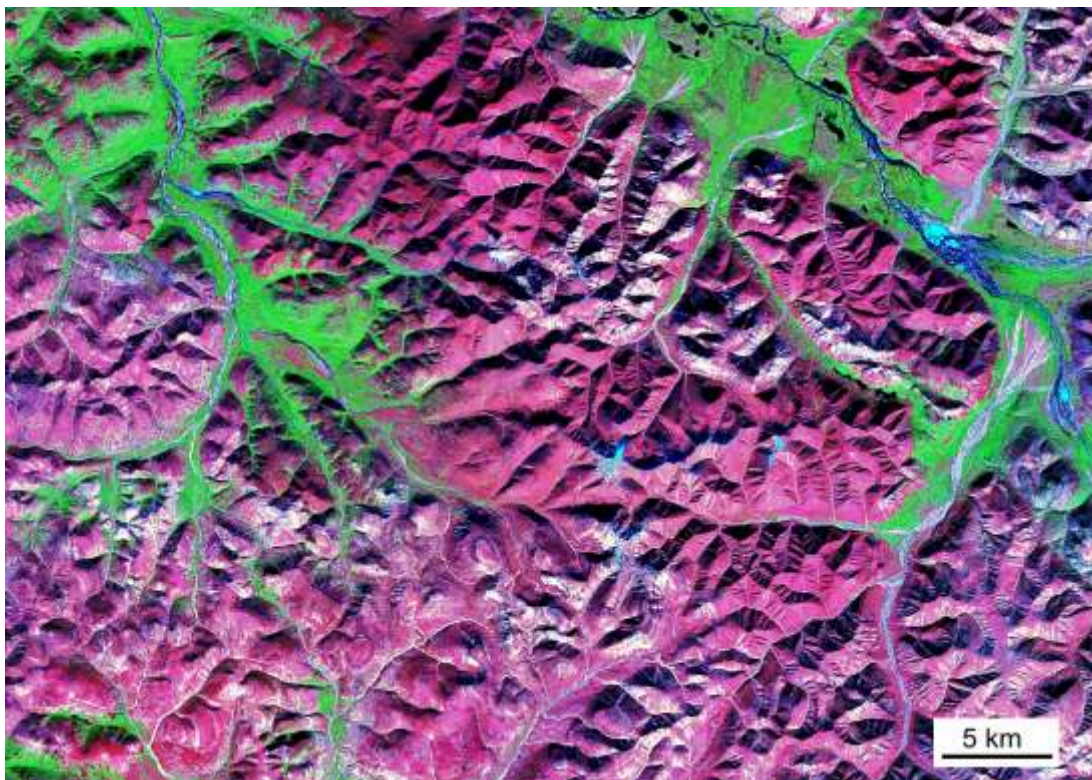
Рис. 3-33. Фрагмент космического снимка (Landsat) Берложьей кальдеры. Темный однородный фототон соответствует риолитовым туфам берложьей толщи, выполняющим кальдеру, а светлый фототон и отчетливо заметное слоистое строение – вулканитам ОЧВП. Местоположение участка показано на рис. 3-29.
