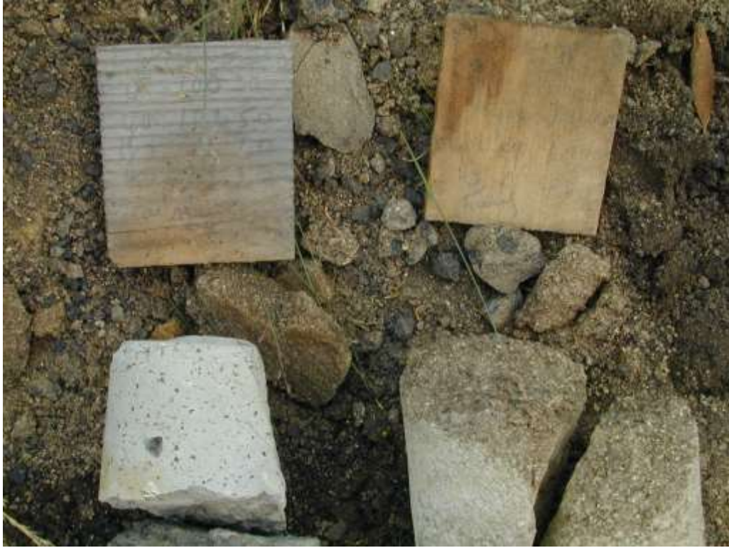
Рис. 3-31. Остатки керна скважин с угольного месторождения Дальнее. Грубозернистые песчаники ольховской свиты (справа) и риолитовые игнимбриты (слева). По сохранившимся рейсовым табличкам можно установить, что эти породы взяты из одной и той же скважины: песчаники – с интервала 72-76 м, игнимбриты – с интервала 100-102 м.
