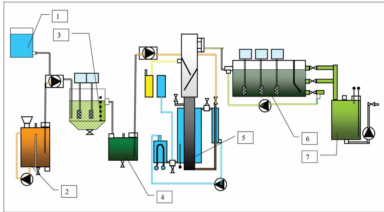
**Рисунок 4 — Технологическая схема пилотной установки биодеструкции РМ вещества типа ви-икс**
