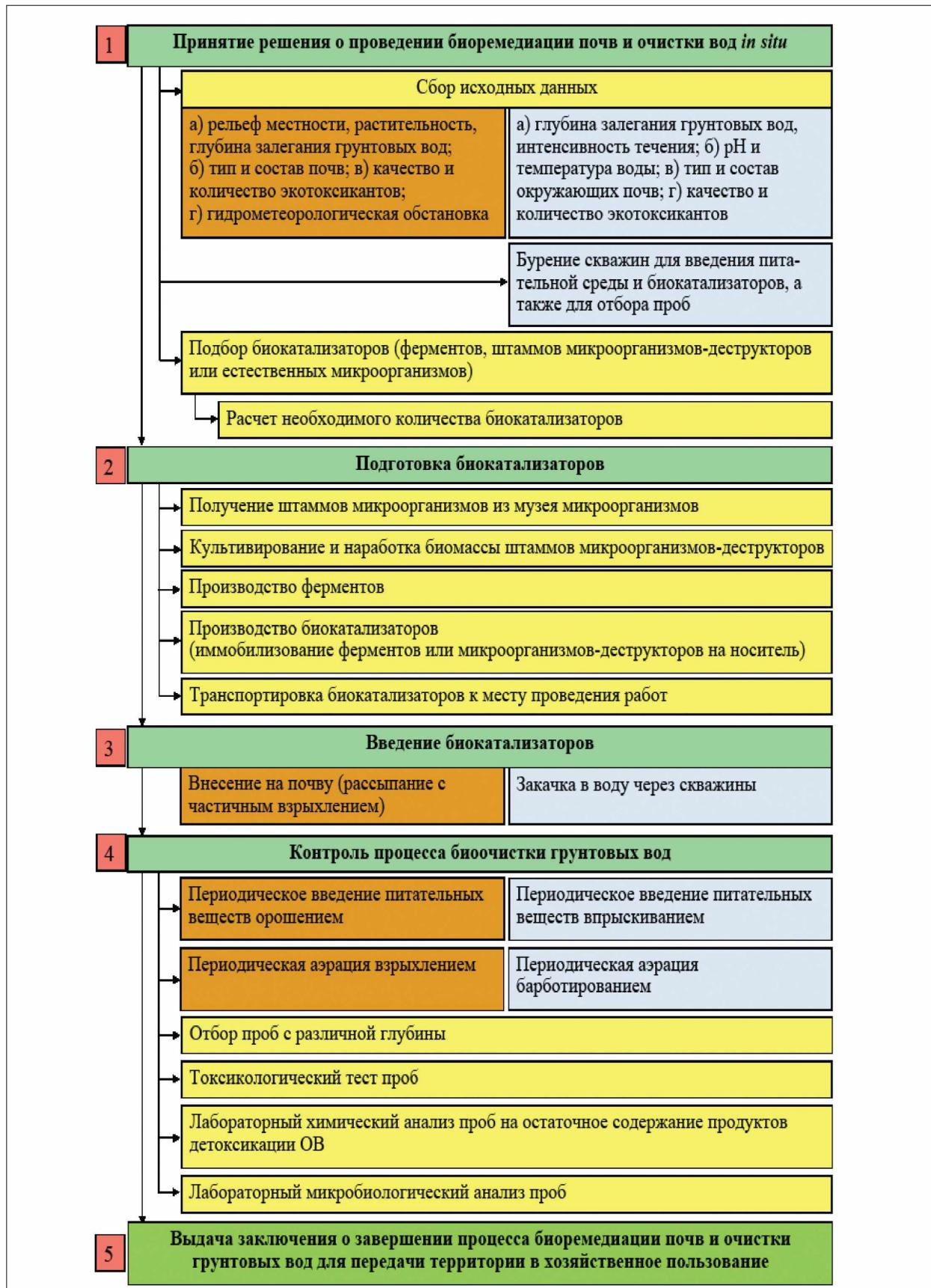
Рисунок 6 — Порядок действий при биоремедиации почв и очистке вод *in situ*
