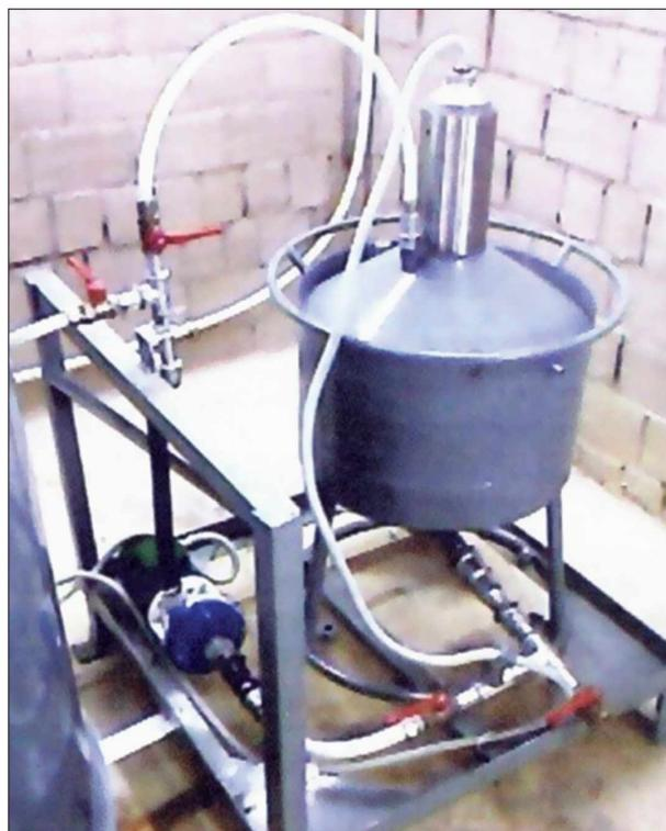
**Рисунок 2 — Реактор пилотной установки для биодеструкции РМ ви-икс с использованием препарата на основе фермента His<sub>6</sub>-ОФГ**
