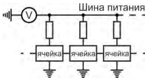
Рисунок 1.15. Схема питания логических элементов в RSFQ логике.
