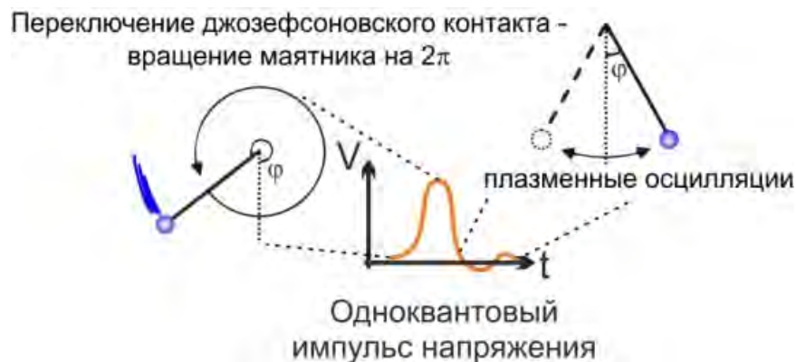
Рисунок 1.7. Одноквантовый импульс напряжения на джозефсоновском контакте, соответствующий переходу через него кванта магнитного потока, и его механическая аналогия с вращением маятника.
