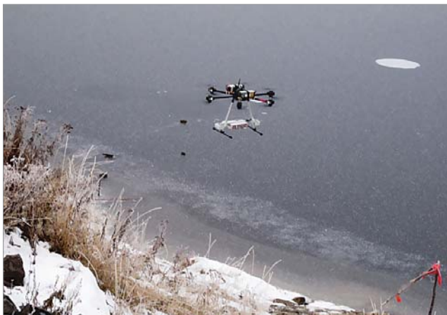
Рис. 1. Уникальная бесконтактная диагностика методом магнитной томографии с применением мультикоптера водного перехода газопровода компании ОАО «АЛРОСА – Газ» через реку Большая Батуобия, Якутия, шириной более 200 м
