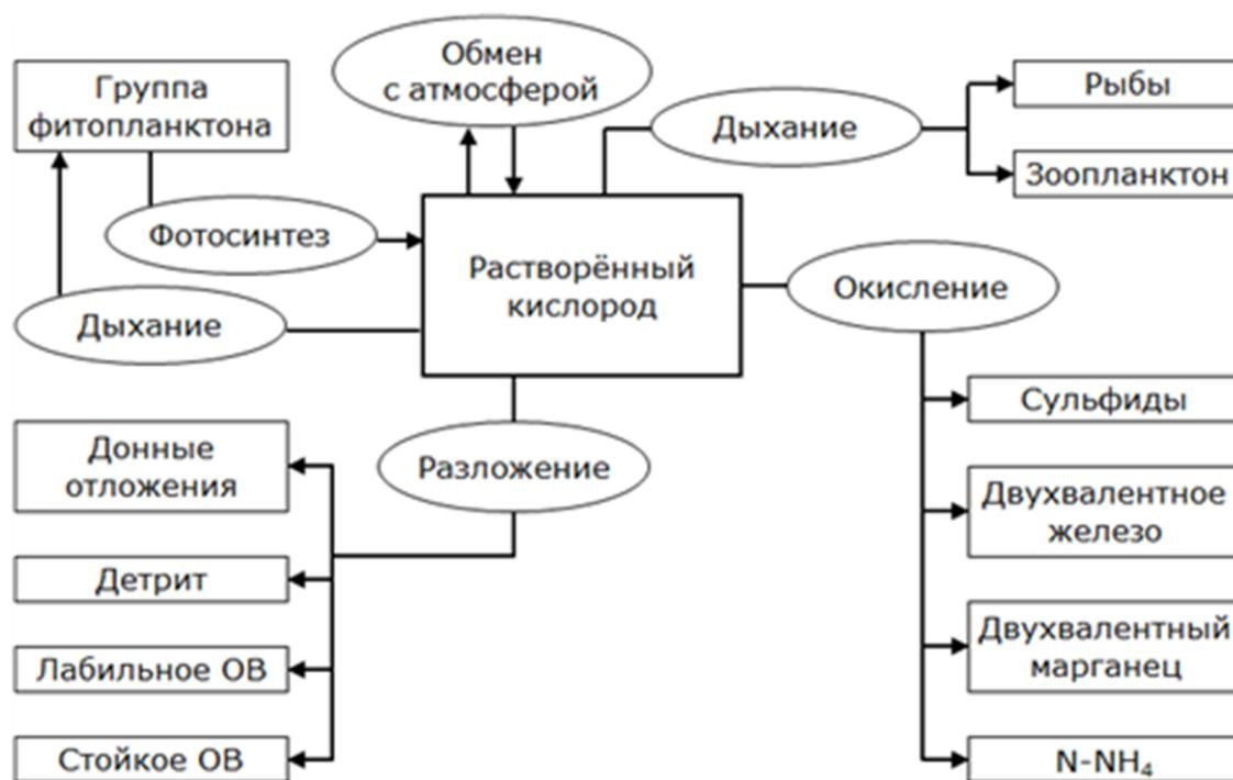
Рисунок 7.5 – Схема процессов в экосистеме водохранилища, определяющих изменение концентраций растворенного кислорода в расчетном боксе
