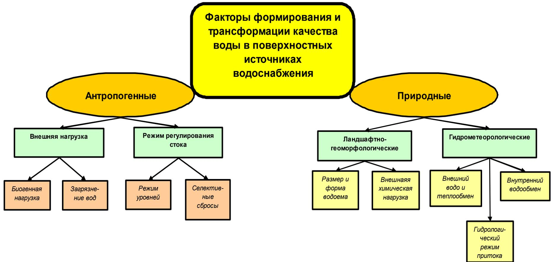
Рисунок 1.10 – Классификация факторов формирования качества воды в поверхностных источниках водоснабжения
