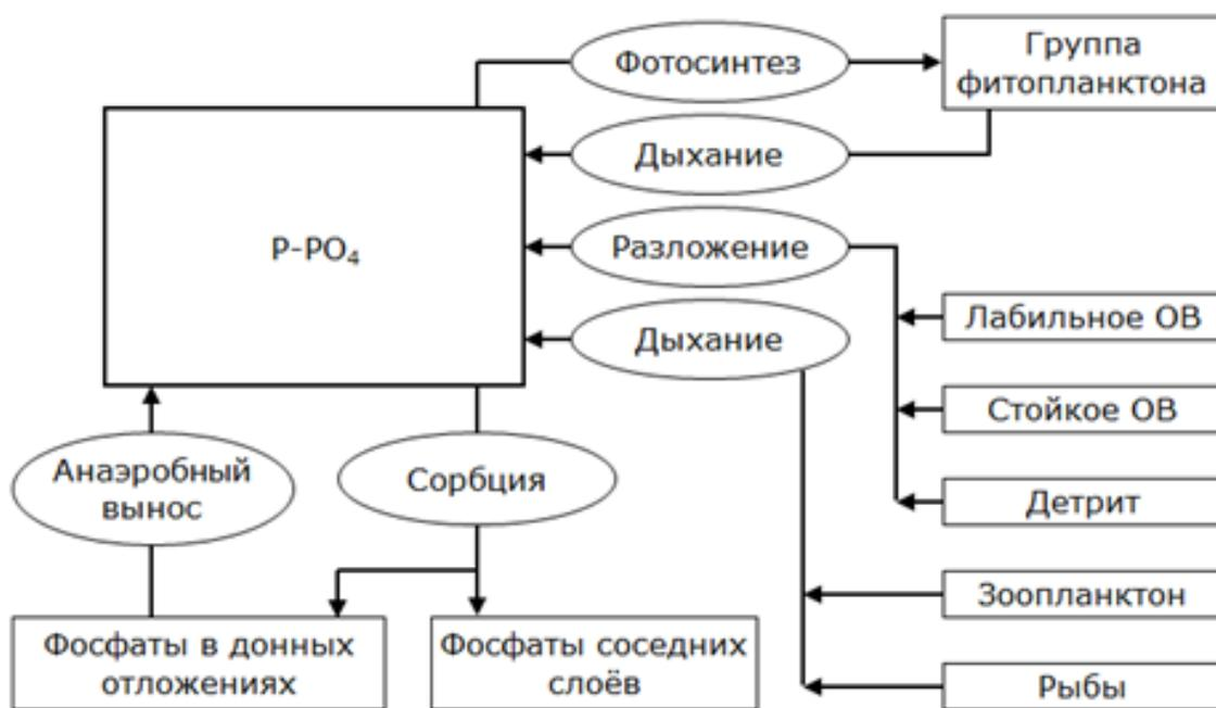
Рисунок 7.6 – Схема процессов, определяющих изменение концентраций фосфатов в экосистеме водоема
