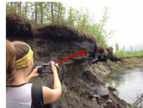
Рис. 5. Использование ИК-камеры (тепловизора) в полевых условиях при исследовании повторно-жильных льдов в обнажении р.Чара (август 2013 г.)
