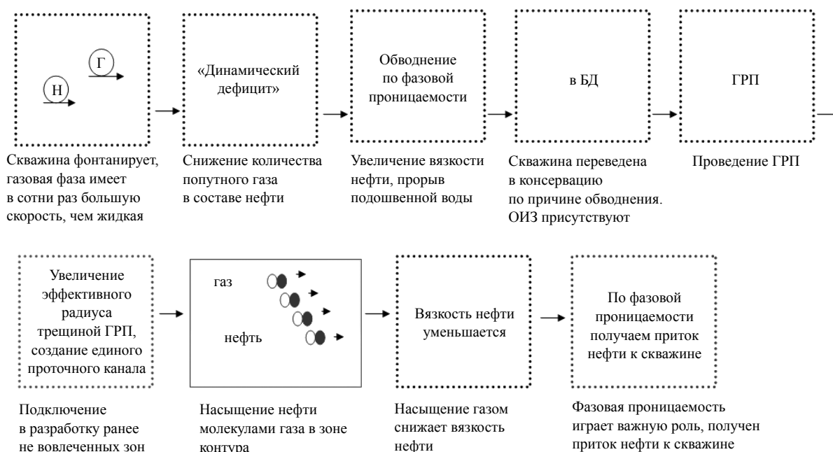
Рисунок 3. Причины преждевременной обводненности скважин и воздействие ГРП на пласты со значительным газовым фактором
