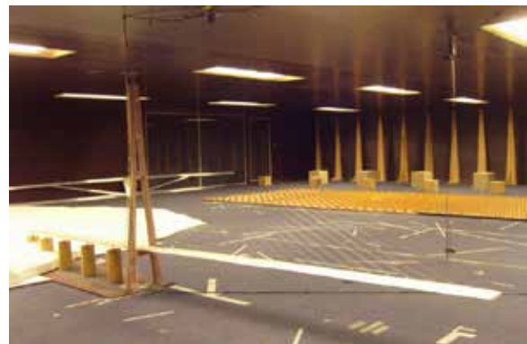
Рисунок 2. Динамически подобная модель вантового моста на стадии монтажа
