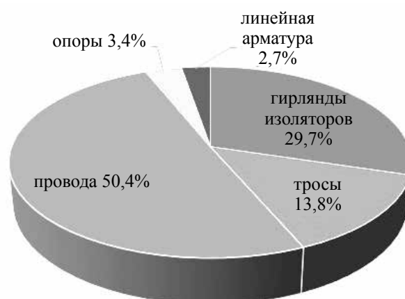
Рисунок 1. Обобщенные данные о повреждаемости элементов ВЛ
