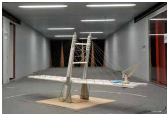
Рисунок 4. Модель вантового моста на стадии строительства
