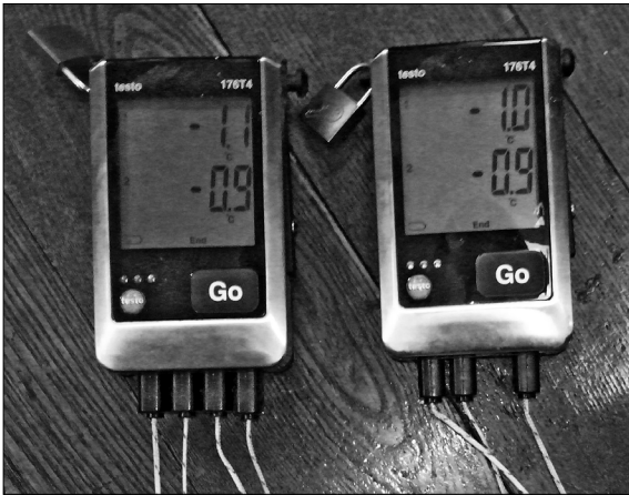
Рис. 3. Логгеры Testo-176-T4 для измерения температуры с комплектом термодпар.
