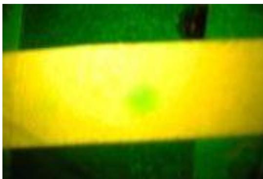
Рисунок 36. Фотография образца, облучённого непрерывным лазерным излучением с дозой 1,8 кДж/см 2 . Фотографирование производится через оранжевый фильтр ОС12 при равномерной засветке образца лазерным излучением на длине волны 532 нм.
