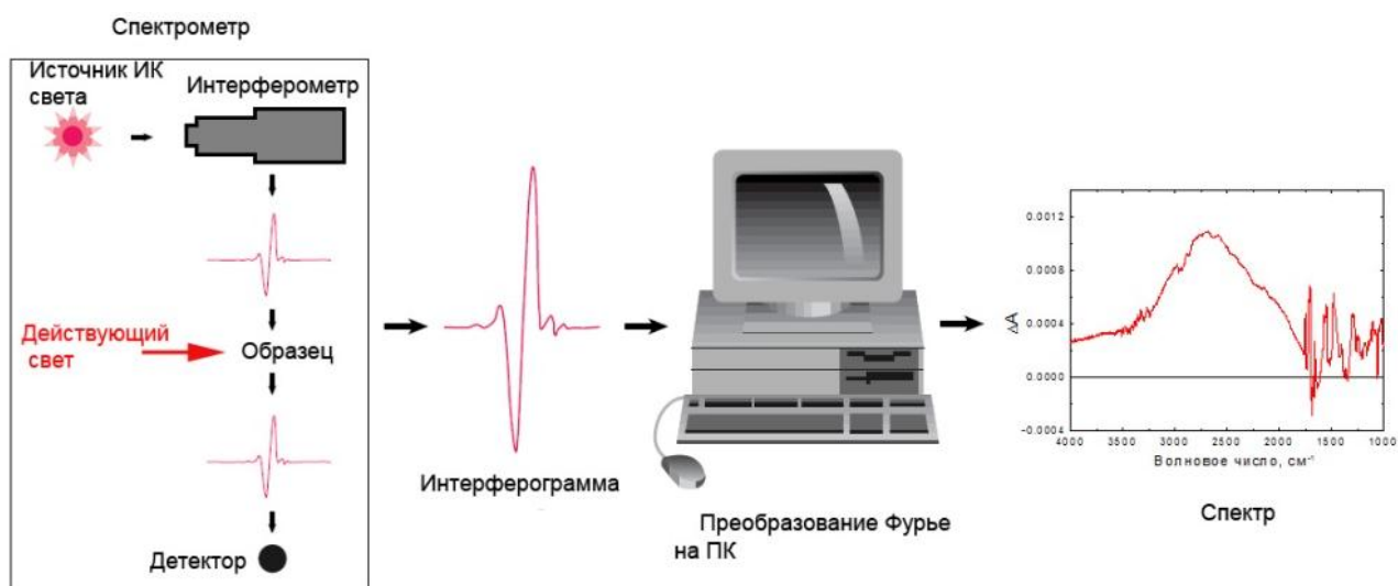
Рисунок 10. Качественная схема получения спектра методом ИК Фурье-спектроскопии. В компьютере производится преобразование Фурье от интерферограммы, измеренной при наличии и в отсутствие образца. Источник рисунка [44].
