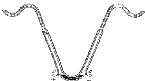
Рис.1.1.1. Схема опыта Ф.Рейсса по электроосмосу (рис. из его статьи 1809 г.)
