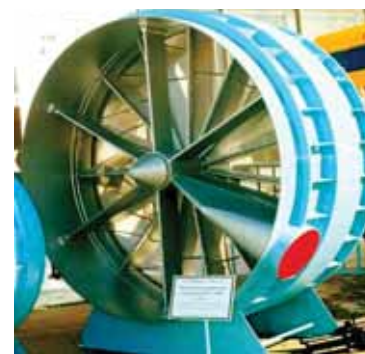
Рис. 4. Внешний вид фильтра предварительной очистки охлаждающей воды типа ФСП-2400
