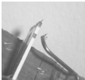
Рис. 2. TF на держателе с прикрепленным к нему углеводородным волокном
