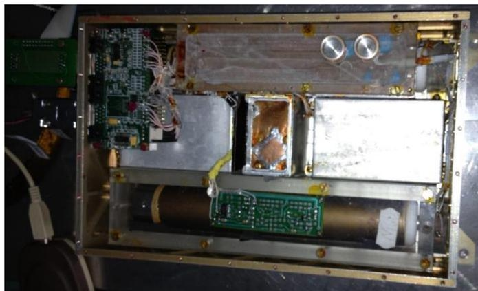
Рисунок 1. — Внутренняя компоновка модулей прибора ДЭПРОН.
