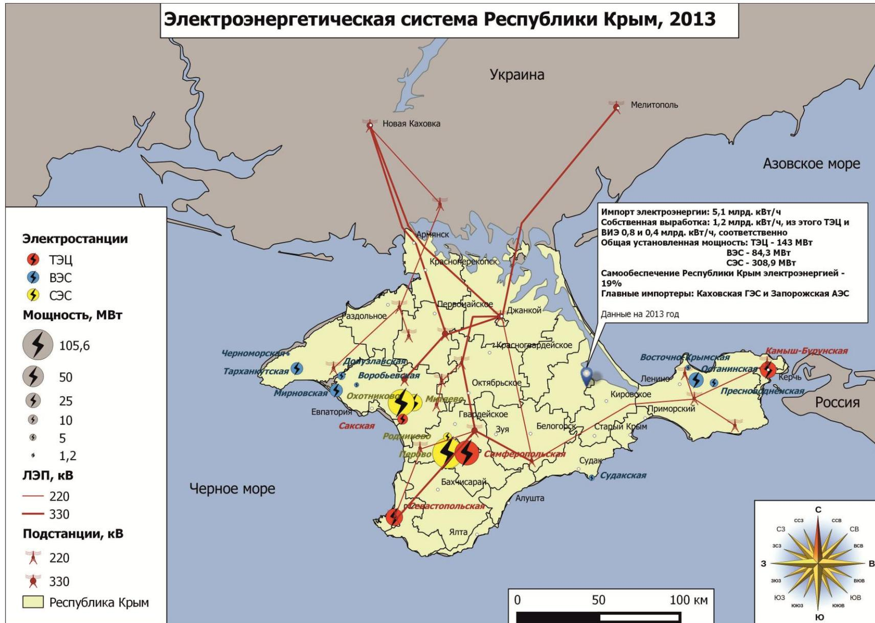
Рис. 13. Электроэнергетическая система Республики Крым и Севастополя, 2013 г.
